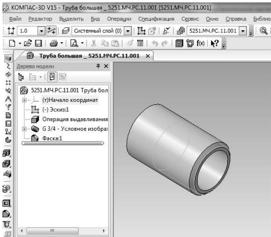
Рис. 2.4. Труба большая 3-D модель
