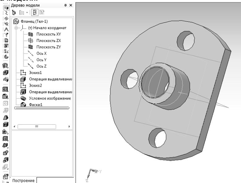
Рис. 2.1.2. Дерево модели детали
