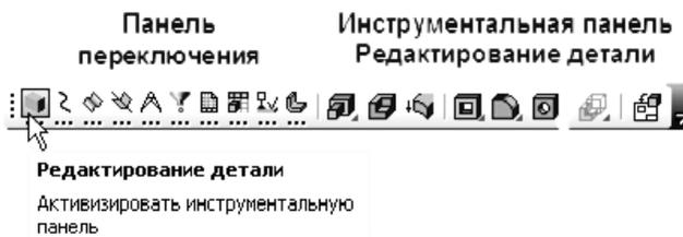
Рис. 2.2.1. Панель переключения, инструментальная панель Редактирование
