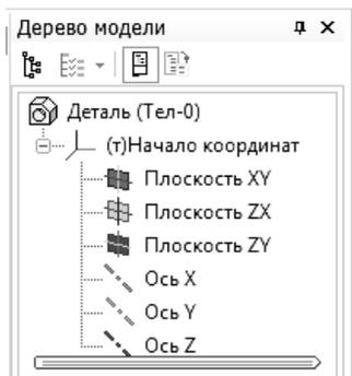
Рис. 2.1.4. Дерево модели детали с виртуальными плоскостями
