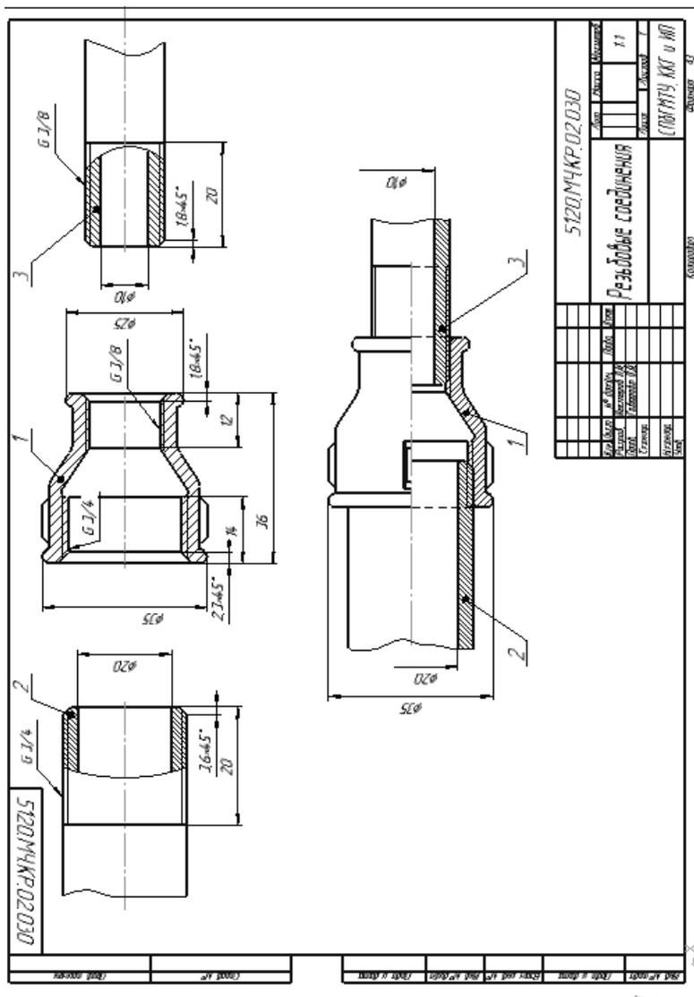
Рис. 2.1. Пример выполнения Сборочного чертежа по теме 2.
